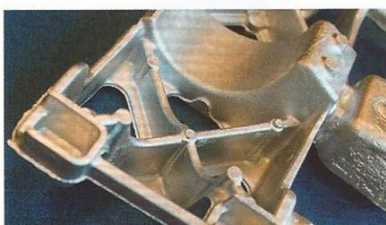
Figura 1 - Peça de um modelo da Jaguar Land Rover, em liga de alumínio. Fonte: [9]
