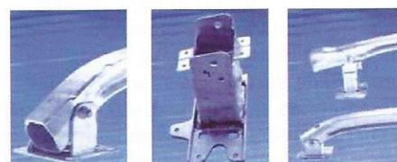
Figura 3 - Componentes de colisão da estrutura frontal e dos para choques do golf-V Fonte: [9]
